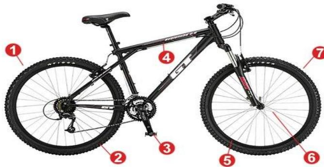
**Возможные ответы:** Педали, обод, заднее колесо, переднее колесо, спицы, шина, рама, передняя вилка, седло, тормоз, задние звездочки.<sup>4</sup>
